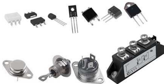
Figura 30 – Principalele tipuri de capsule ale tiristoarelor. Tipurile de capsule amintesc de cele ale tranzistoarelor de mică, medie și mare putere.
