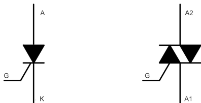
Figura 31 - Tiristoarele Simbolul arată că tiristorul este o diodă A și K la care a fost asociată a treia ieșire, grila sau poarta. Triacul este figurat ca două diode cuplate în paralel și în opoziție cu terminalele A1, A2 la care a fost asociată a treia ieșire, grila sau poarta sau echivalent cu două tiristoare legate în paralel și în opoziție.
